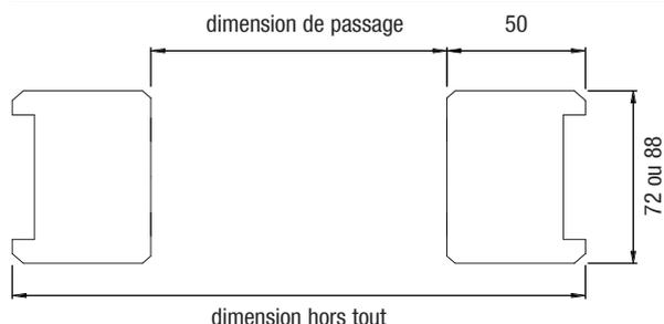
donner les dimensions de réservation maçonnerie limites dimensionnelles des réservations : largeur de 690 à 2200 hauteur de 2000 à 2300
