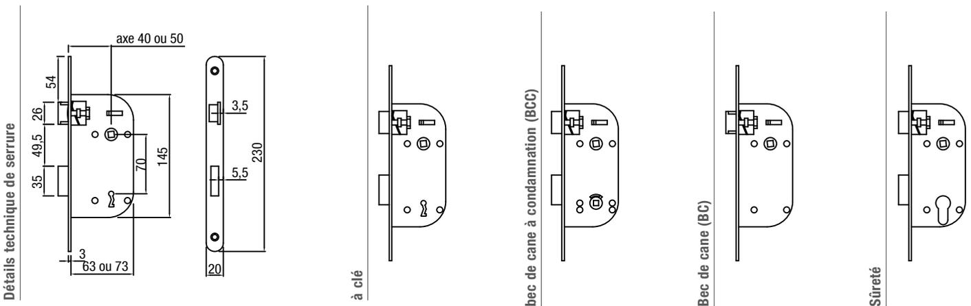
Porte à RIVE DROITE : serrure 3 points automatique (pour porte hauteur comprise entre 1990 et 2110 mm) axe 50 mm. 3 pènes sur coffres. Cylindre Européen 30/30 avec 2 clés, fourni.
