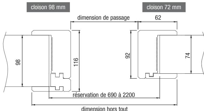
donner les dimensions de réservation maçonnerie limites dimensionnelles des réservations : largeur de 690 à 2200 hauteur de 2000 à 2300
